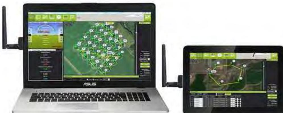
Tramite un software specifico, l'operatore programma una rotta di volo automatico e una serie di voli manuali, in base all'area da sorvolare, al tipo di risultato e alla risoluzione che si vuole ottenere
